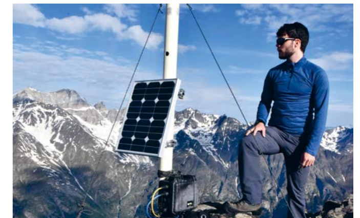
Mit einem Netzwerk aus drahtlosen Sensoren haben Forscher:innen über mehrere Jahre hinweg die Felsbewegungen in den Schweizer Alpen untersucht. Die Resultate liefern neue Erkenntnisse, wie man Bergstürze in Permafrostgebieten frühzeitig erkennen kann.
